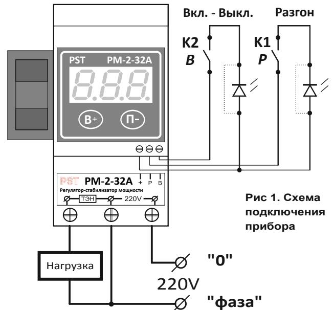
Рис 1. Схема подключения прибора
